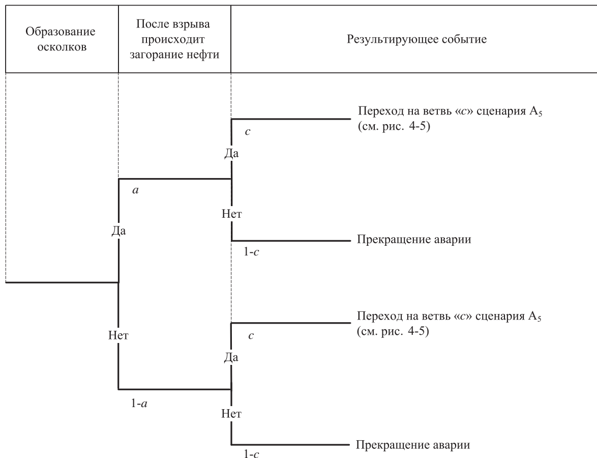
Рис. 4-6. Дерево событий при взрыве внутри подземного резервуара (типа ЖБР) (сценарий A_6 )
